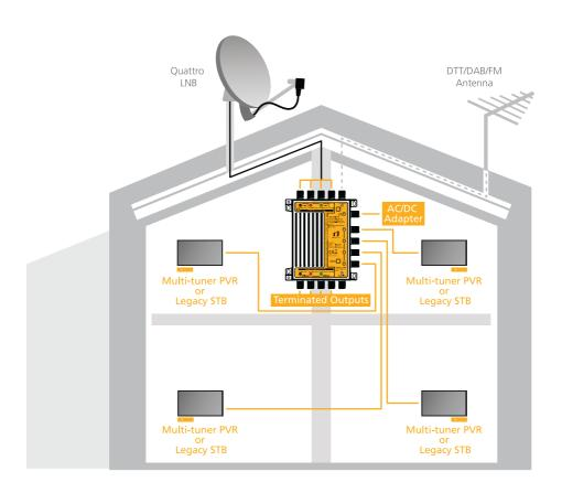
Verbinden Sie die Kabel vom Quattro LNB entsprechend mit den Eingängen V/L, V/H, H/L. H/H (achten Sie auf die Bezeichnungen der Quattro LNB Ausgänge). Der Multiswitch ist mit terrestrischem Eingang ausgestattet. Verbinden Sie das Kabel, kommend von der terrestrischen Antenne, mit dem "Terrestrial Input Port".
