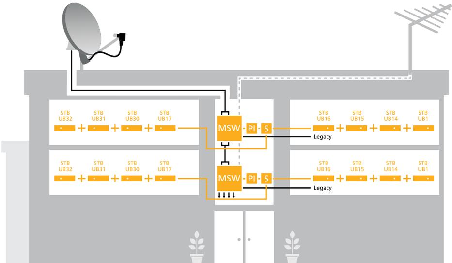
Verbinden Sie die Kabel des Quattro-LNBs mit den Anschlüssen, beschriftet mit: LNB V / L, V / H, H / L und H / H- (achten Sie auf die Identifizierung der Quattro-LNB-Anschlüsse). Der Multischalter ist mit einem terrestrischen Eingang ausgestattet. Schließen Sie die terrestrische Antenne an diesen Eingang an:
