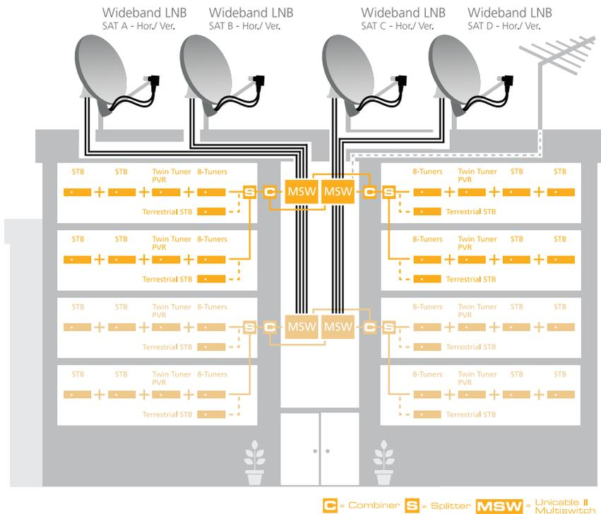
Verbinden Sie die Kabel vom Wideband LNB mit den Eingangsanschlüssen, die mit SAT A/C Vertikal und Horizontal sowie Sat B/D Vertikal und Horizontal, markiert sind (Achten Sie auf die Identifizierung der Wideband LNB Anschlüsse).
