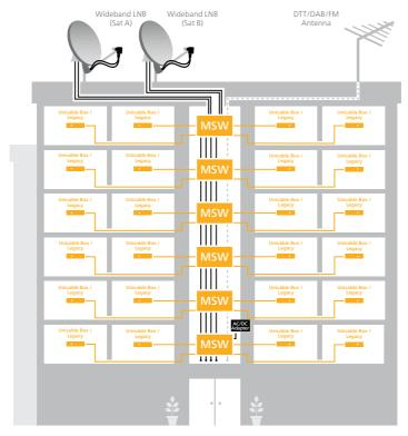
Das folgende Diagramm zeigt den Empfang von vier Satellitenpositionen über Wideband-LNBs. Jeder STB kann auf jeden Transponder der vier Satelliten zugreifen:
