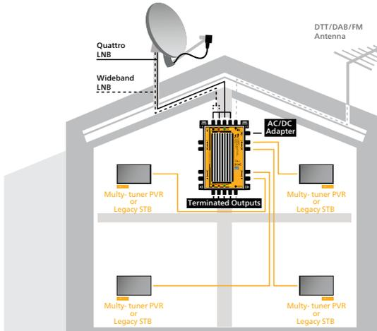
Das folgende Diagramm zeigt eine typische MDU/Gebäudeinstallation mit zwei Wideband-LNBs für zwei Satellitenpositionen:
